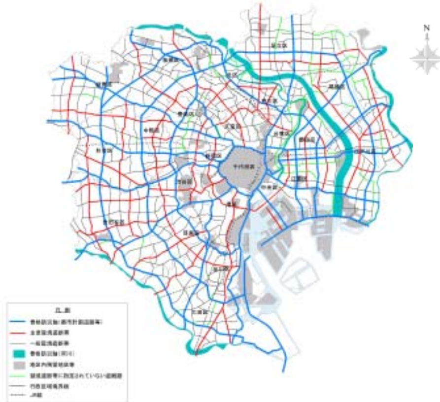
図 2-6 延焼遮断帯（「防災都市づくり推進計画(基本計画)」東京都都市計画局、平成15年10月より）
