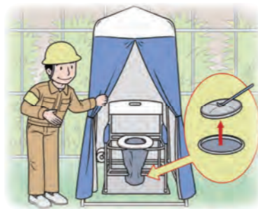
防災トイレ(マンホールトイレ)
