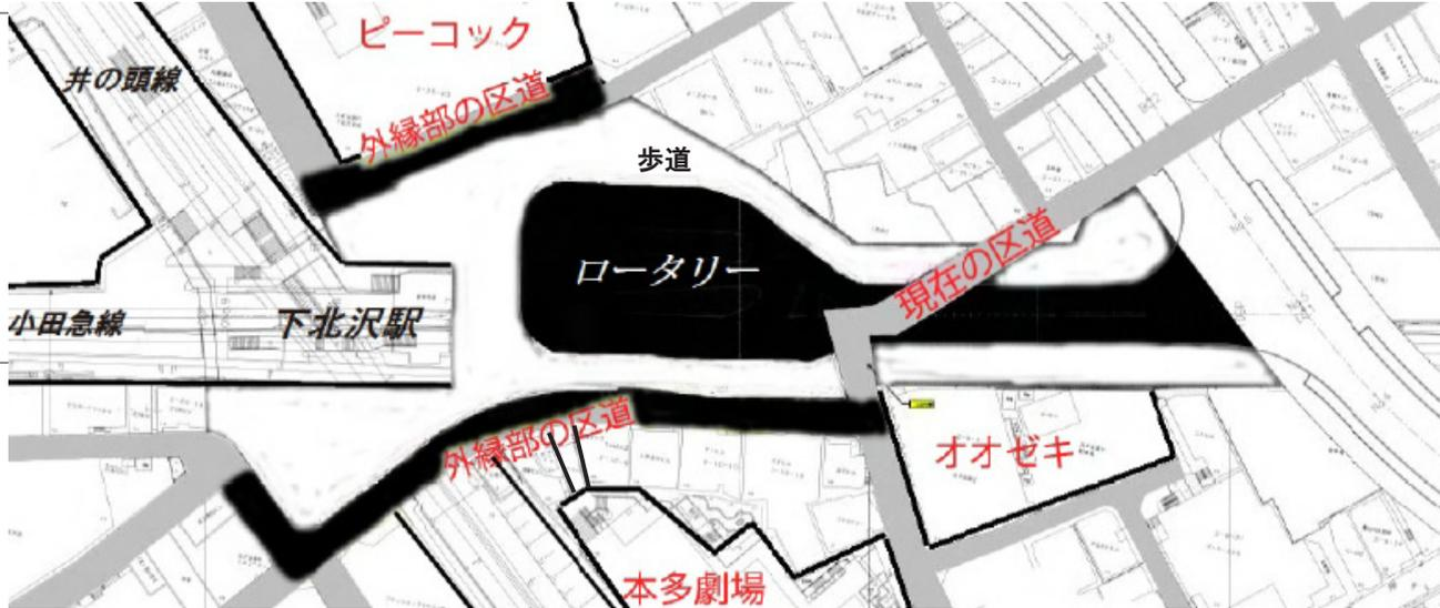
図3： 区画街路10号線（5400㎡の駅前交通広場と幅25mの補助54号線からの導入道路）平面図
