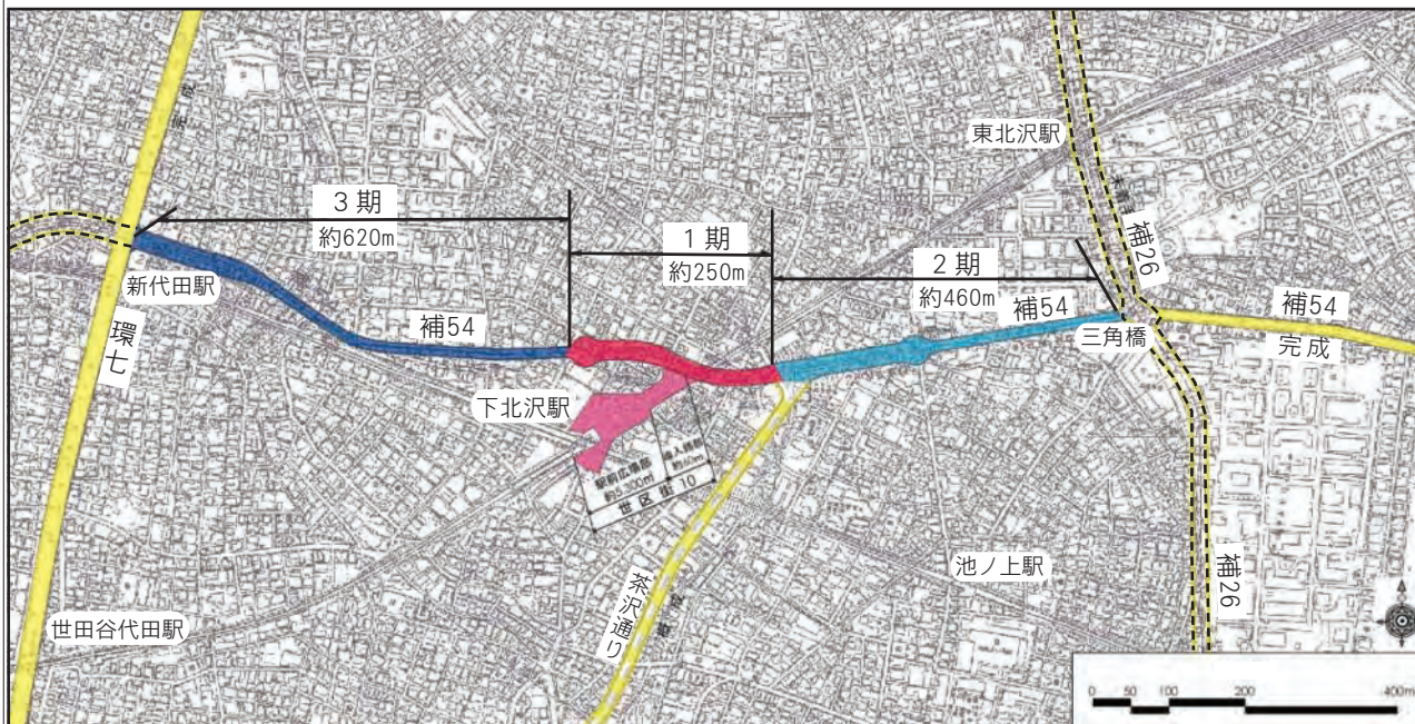
都市計画道路・補助54号線は、補助26号線(三角橋)から環7(新代田)へと、1-3工期に分け住宅街・商店街を貫通する。
